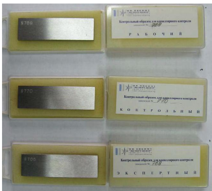
Рис. 3.2. Рабочие и контрольные образцы для капиллярного контроля
